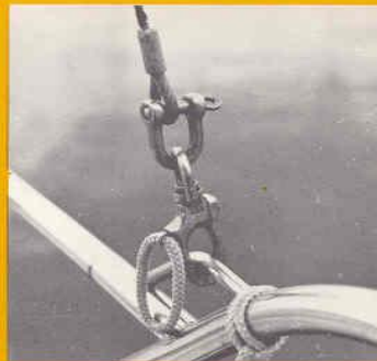
Mousqueton facile à ouvrir, frappé sur un pontet.
