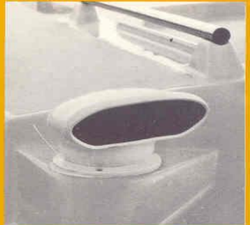
Aération du carré parfaitement étanche.
