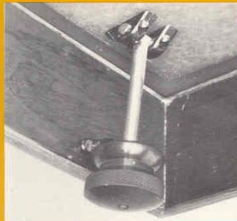
Pour fermer un capot étanche : tire-bord à vis.
