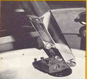
Une ferrure de barre usinée dans la masse.
