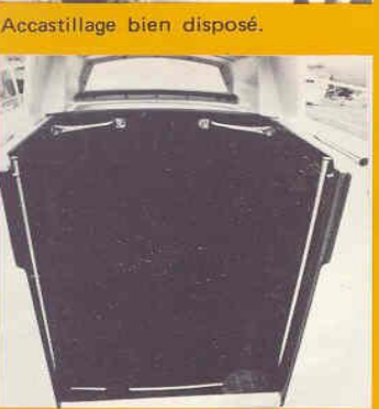
Poignées pour descendre. Mains courantes pour remonter.
