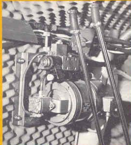
appareillage hydro-électrique du pilote
