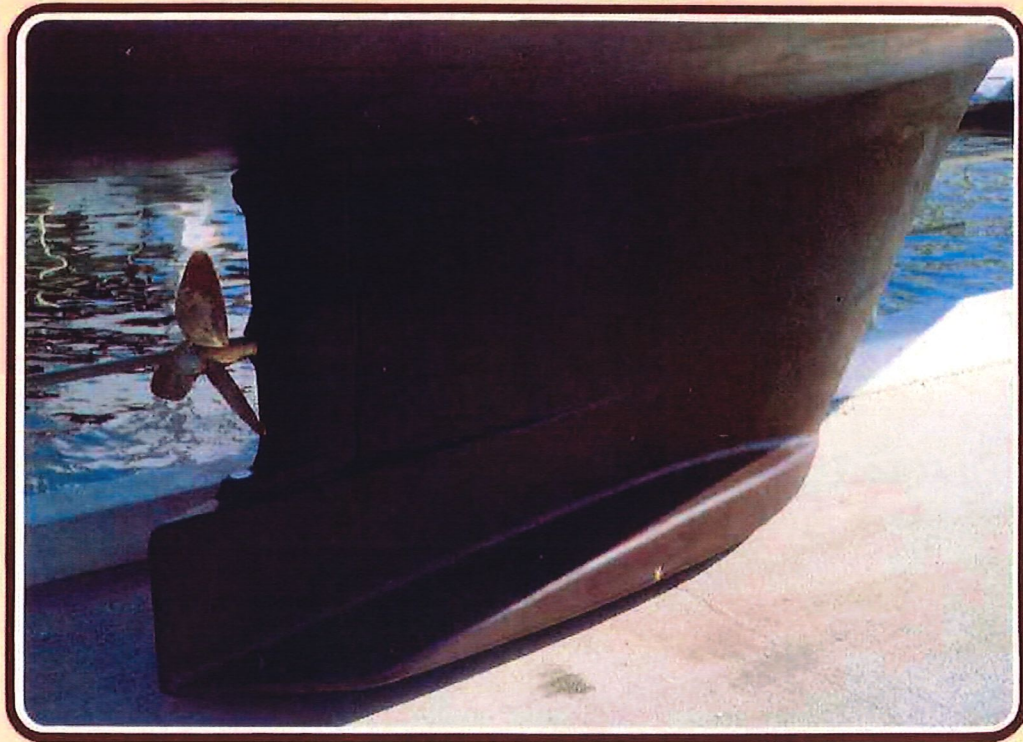
le système de propulsion Amel et ses ailerons
