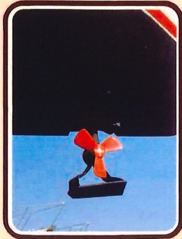
le propulseur d'étrave rétractable Amel
